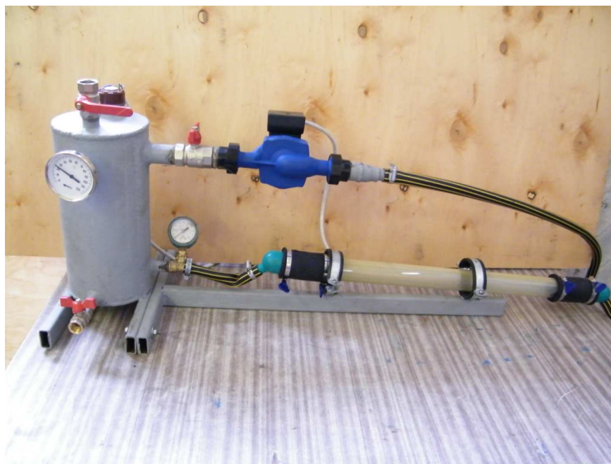
Рис. 2.1 Лабораторна демонстраційна модель для виробництва біодизель Основні технологічні вузли і агрегати установки вказані на рис. 2.2
